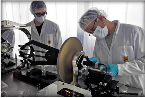
Integrazione in clean room di un telescopio spaziale OS per Earth Observation
